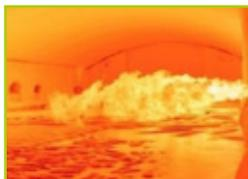
Le calcin est envoyé dans un four à 1 600°C. À cette température, il rentre en fusion.
