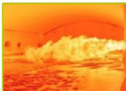
Le calcin est envoyé dans un four à 1550°C. A cette température il rentre en fusion
