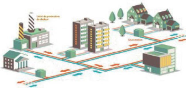
Une unité de production (ici, le SIAVED) génère de la chaleur qui est injectée dans le réseau pour alimenter des bâtiments en chauffage et eau chaude sanitaire.
